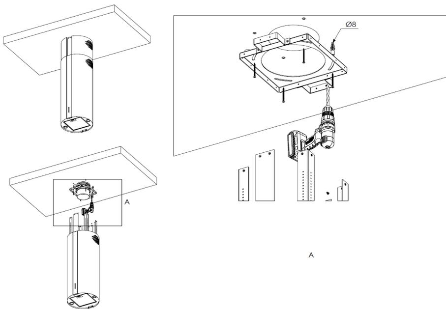
Анкер (поставляется в комплекте) крепится к потолку так, как это показано на рисунке выше. Вытяжка оборудована крепежным элементом для крепления к потолочному анкеру. Установите вытяжку на анкер.
