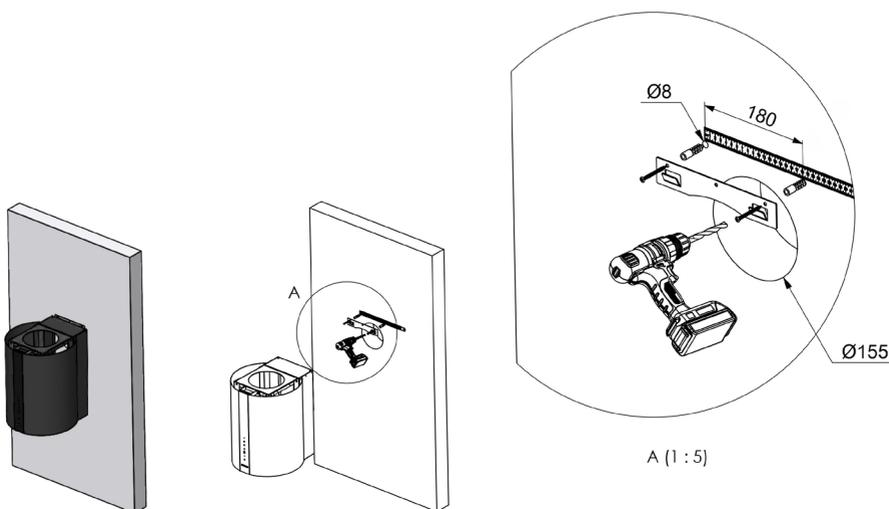
Анкер (поставляется в комплекте) крепится на стену так, как это показано на рисунке выше. Вытяжка оборудована крепежным элементом для крепления к настенному анкеру. Установите вытяжку на анкер.
